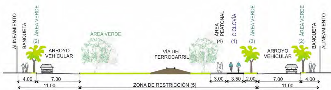
CORREDOR VERDE ADYACENTE A LA VÍA DEL FERROCARRIL
